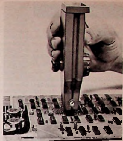
Afb. 1. De Fluke Trendar 200 testclip is de eerste eenheid, die testapparaten in zich verenigt.
